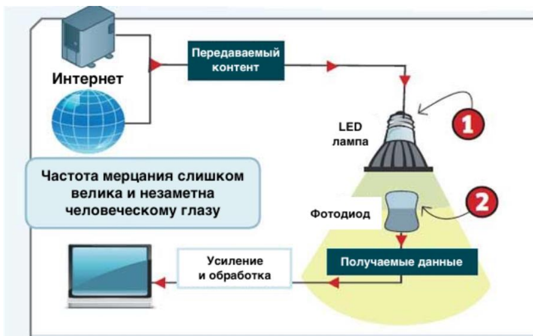
Рисунок 1.3 – Принцип работы системы Li-Fi
